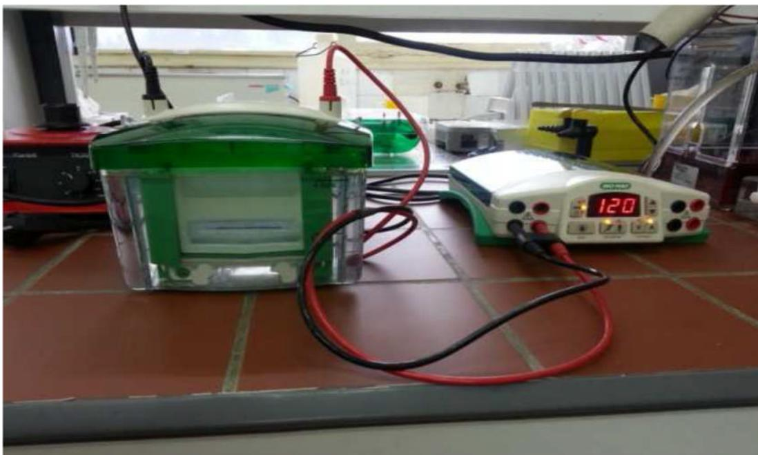
الشكل (13): تقنية الفصل الكهربائي للبروتينات
